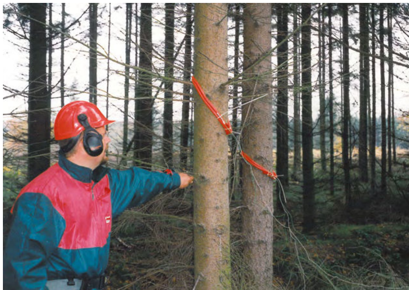
Forberedelse til sprængning af grantræer med sprængsnor
