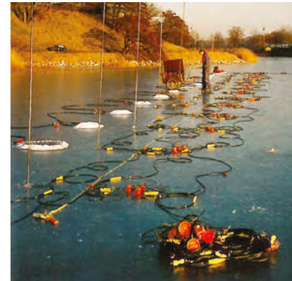
Refraktionsseismiske undersøgelser på Stadsgraven i forbindelse med den første metro i København, isvinteren 1996-97. Til venstre bores et hul i isen hvor i ladningen på 100 g efterfølgen sænkes ned i. Foto: Uffe Nielsen, Rambøll
