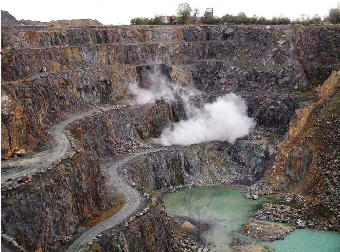
Sprængning i Rønne Granitbrud, NCC Roads. Nederst ses bænke, der er klargjort til sprængning. Billede nederst til højre viser udsprængning af bloksten, Zurface.
