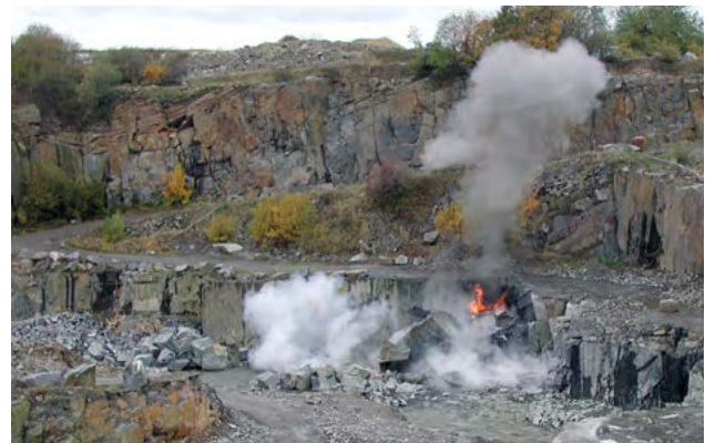
Sprængning i Rønne Granitbrud, NCC Roads. Nederst ses bænke, der er klargjort til sprængning. Billede nederst til højre viser udsprængning af bloksten, Zurface.
