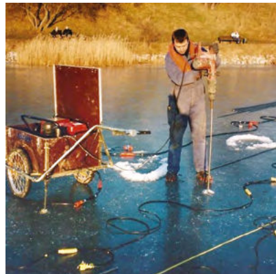
Refraktionsseismiske undersøgelser på Stadsgraven i forbindelse med den første metro i København, isvinteren 1996-97. Til venstre bores et hul i isen hvor i ladningen på 100 g efterfølgen sænkes ned i. Foto: Uffe Nielsen, Rambøll
