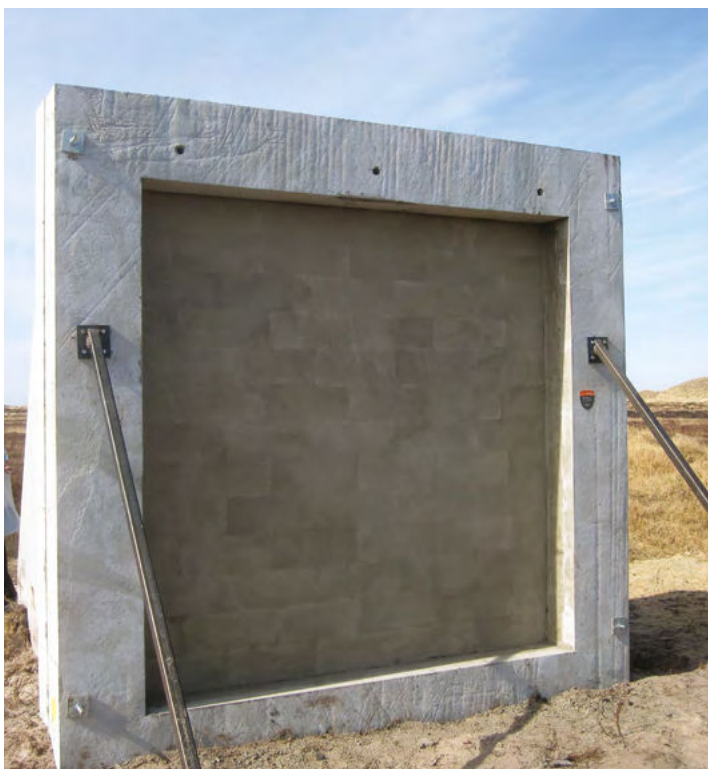
Forstærket vægparti før og efter sprængning af 500 kg TNT i ca. 25 m afstand
