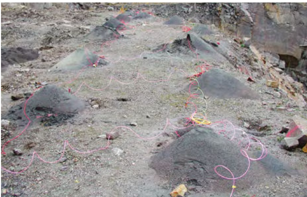
Sprængning i Rønne Granitbrud, NCC Roads. Nederst ses bænke, der er klargjort til sprængning. Billede nederst til højre viser udsprængning af bloksten, Zurface.
